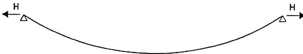
4.3. ábra A kábel húzóereje
